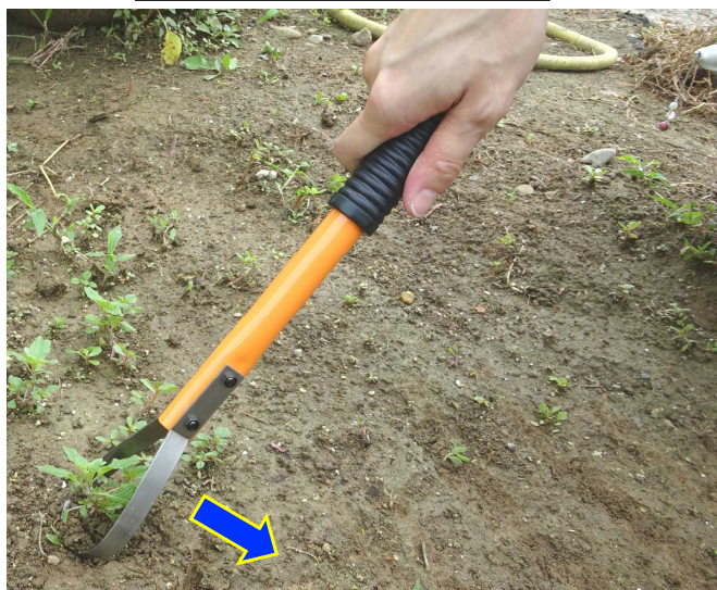
刃の先端部を手前に引いて使う除草
