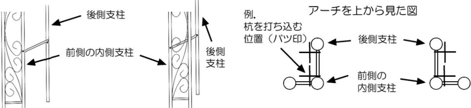
2. フラワーアーチを移動し、印を付けた所に⑬羽根付杭を打ち込む。
